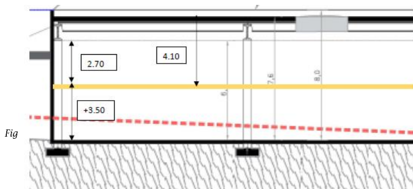
Plan de détail du stockage et mezzanine
